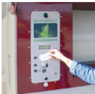
**A sinistra: Il presscontainer; a fianco: le operazioni di lettura della card e verifica dell'abilitazione all'utenza del sistema.**
